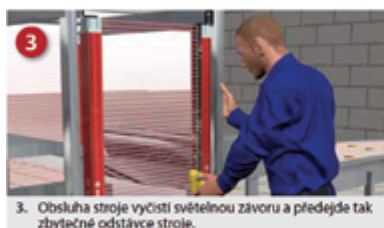
3. Obsluha stroje vyčistí světelnou závoru a předejde tak zbytečné odstávce stroje.
